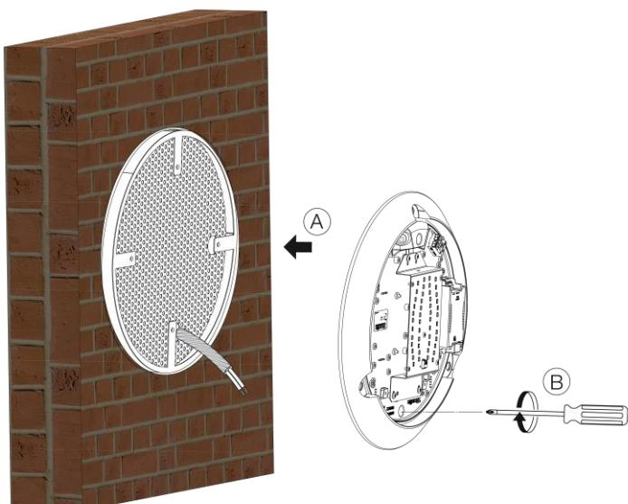
Fixer le luminaire (VOILA ou EFFICE) sur le support à l'aide du kit de fixation fourni.
